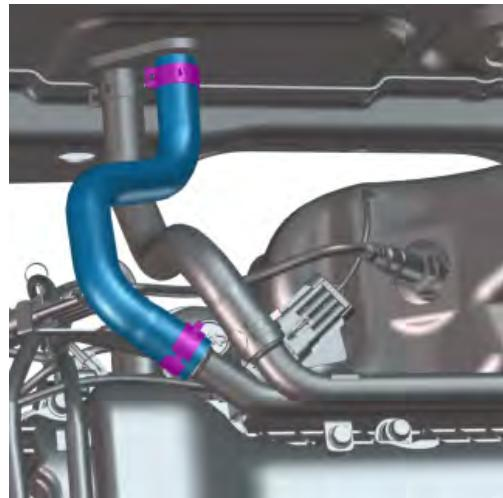
安装软管。安装夹子。
