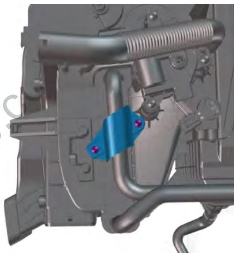
卸下两个紧固件。拆下顶盖。
