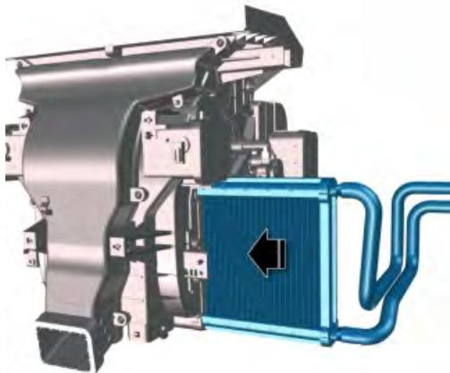
安装加热器核心和加热器管。确保密封件正确对齐。
