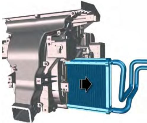
卸下加热器核心和加热器管。
