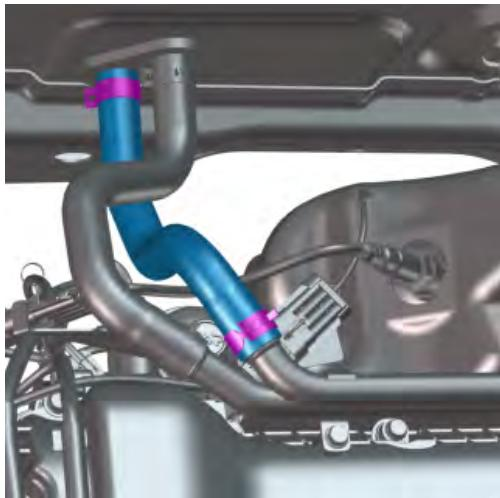
安装软管。安装夹子。
