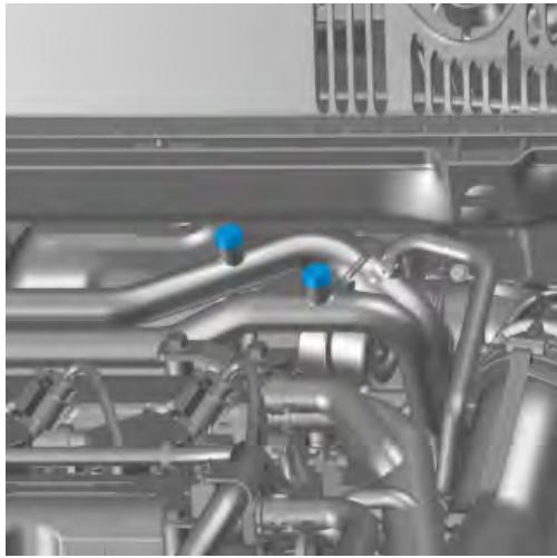
将正确的冷却液注入冷却系统。有关规格，请参阅冷却液和容量打开两个盖子放出冷却系统中的气体。冷却液从放气阀流出时，安装盖子。
